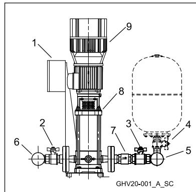
Alt etter type enhet, kan tilbakeslagsventilen være installert på trykk- eller innsugingssiden. Elektropumpen kan være vertikal eller horisontal. Tanken følger ikke med.
