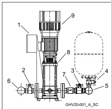
A seconda del tipo di gruppo la valvola di ritegno può essere in mandata o in aspirazione, l'elettropompa può essere del tipo verticale od orizzontale. Il vaso non è fornito.
